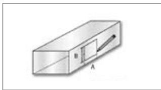
5. Tracciare le dimensioni del foro (225 x 145 mm) secondo il modello del prodotto utilizzando la dima fornita a corredo per la serie BXMC.
