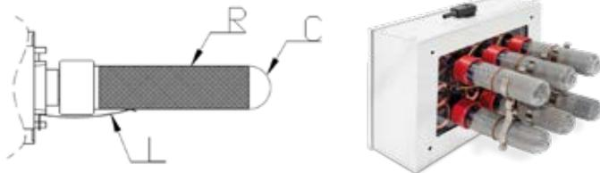
9. Non appena si nota uno strato biancastro sulla griglia di metallo all'interno del condensatore, significa che questo va sostituito.
