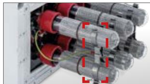
3. Attaccare la linguetta metallica al condensatore e accertarsi che la rete esterna coincida con quella interna.
